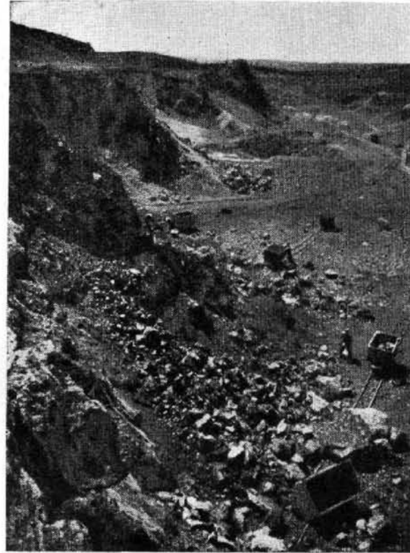
5. ábra. Kézi rakodás vegyes kőzetű munkahelyeken
