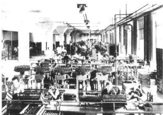
Rádiócsőgyártás automata rendszerű gépeken az 1930-as évek elején.
