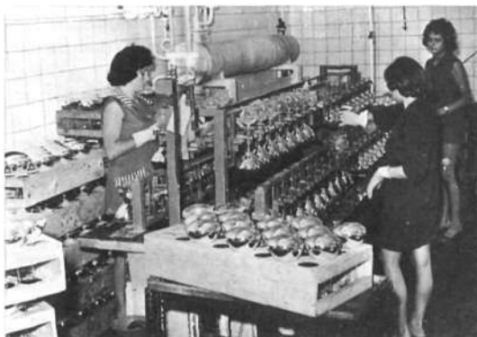
Infralámpa tükröző-bevonatának készítése, 1968 körül.
