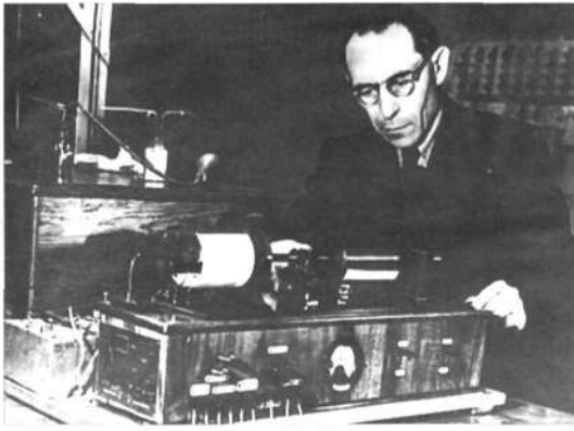
Selényi Pál és az elektrosztatikus képátviteli kísérleti berendezés, 1930-as évek vége.
