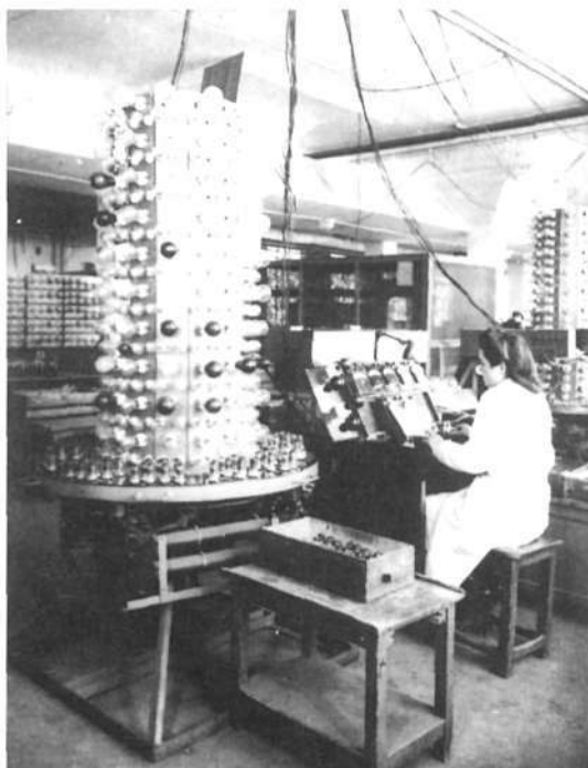
A 21-es sorozatú ún. "szinüveg"-rádiócsővek égetése és mérése saját készítésű berendezéseken.
