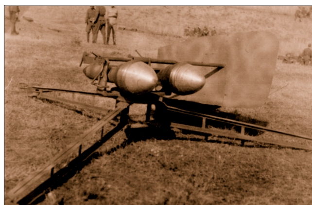
186. ábra: A prototípusok kipróbálására szolgáló tripod állvány, amely csak a kiképzést szolgálta (A. B.)
