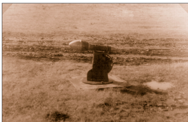
185. ábra: Az első próbaindítás kezelő nélkül, satus fix állványról a Buzogányvető prototípussal – valószínűleg Várpalotán (A. B.)
