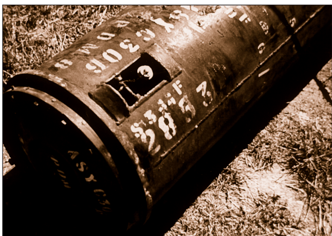
214. ábra: A C 306 akna víznyomásmérője (B. J.)
