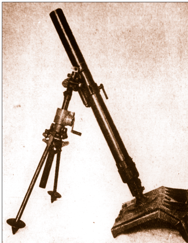
140. ábra: Az 1936/39 M. típusú 81 mm-es aknavető (S. Gy.)
