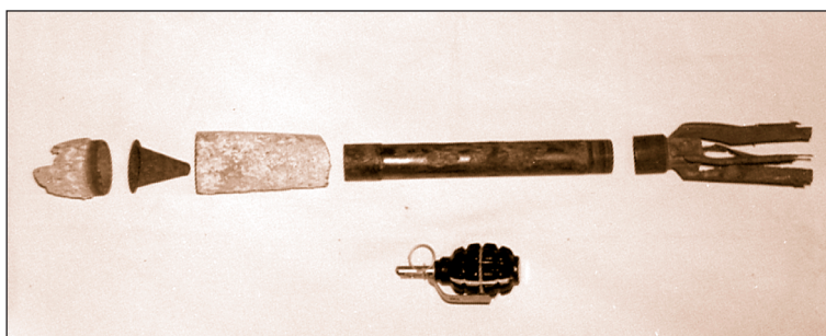
175-176. ábra: Az MH Tűzszerész Zászlóalj által korábban mentesített 1944 M. rakéta páncélrobbantó gránát részei (Hatala A.)
