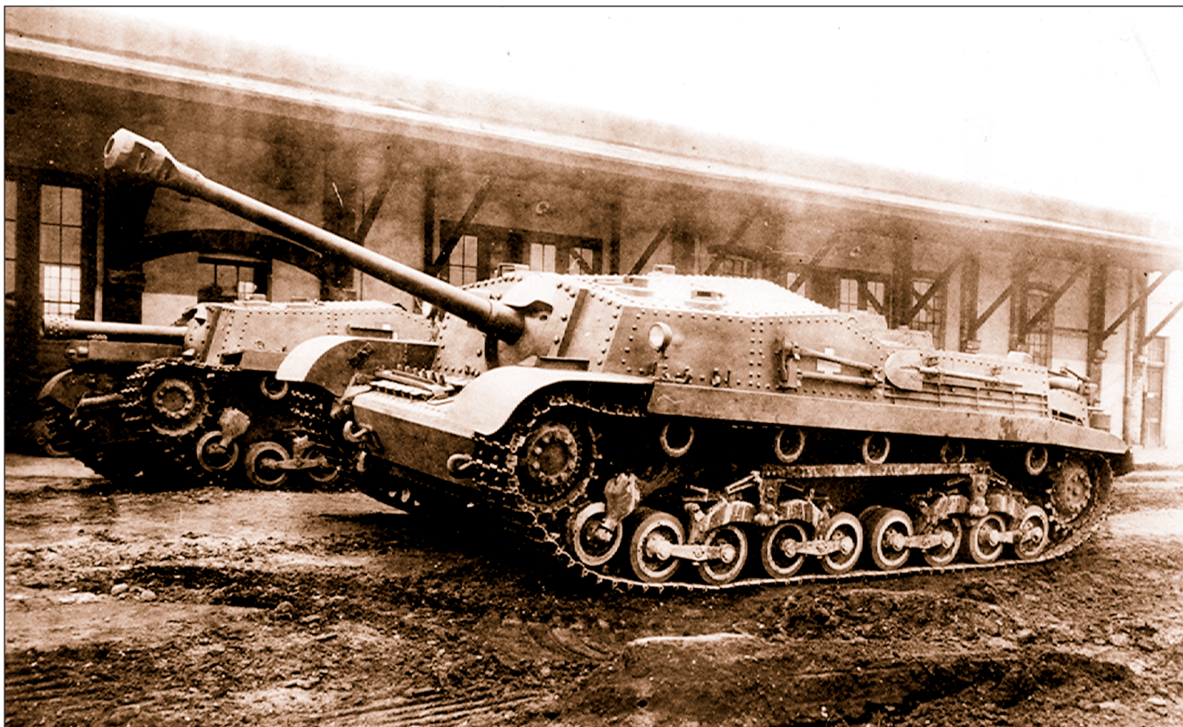
123. ábra: Az 1944 M. Zrínyi I. rohamágyú prototípusa a 75 mm-es páncéltörő ágyúval a Tüzér szertár udvarán 1944 őszén (S. Gy.)
