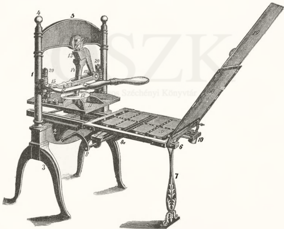
23. ábra. Washington kézi sajtó. 1. Oszlopok. 2. Sintartó. 3. Talapzat. 4. Diszítés. 5. Sajtógerenda. 6. Sinek. 7. Támasz. 8. Könyökhajtó. 8a. Dob vagy szijkorong. 9. Nyomóalap. 10. Nyomófedél. 11. Nyomófedél ellensulya. 11a. Tégely. 12. Vezetőoszlop csapágya. 13. 14. Csuklódarabok. 15. Vonórúd. 16. Vonókönyök. 17. Nyomásszabályozó. 18. Nyomófedél timpánnal. 19. Kisebb keret. 20. Tégelyrugók. 21. Tégelytartó.
