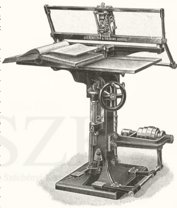
323. ábra. Lábbal hajtható számozógép.
