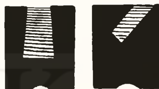
297. ábra. Több darabból összerakható, szegeltető vasalátét. Kempewerk gyártmánya.
