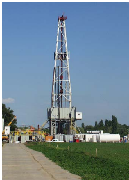
Rig-3 Diesel-elektromos fúróberendezés
