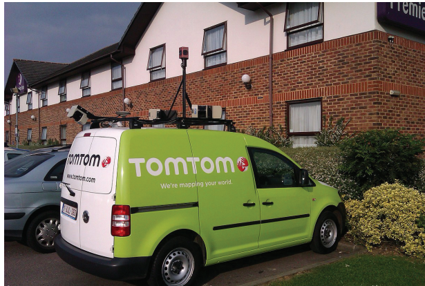
14. ábra: A TomTom cég 5 LiDAR készülékkel felszerelt furgonja 66
